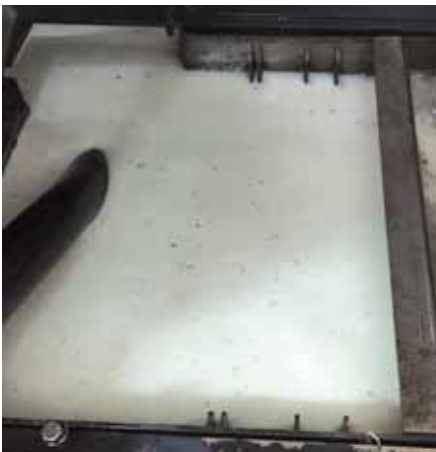
Vor der Reinigung mit dem Diedron Filter befinden sich zahlreiche Partikel im Kühlschmierstoff.
