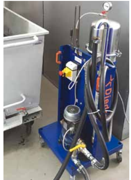
Die Nebenstromfilter-Anlage lässt sich mobil an unterschiedlichen Maschinen nutzen.
