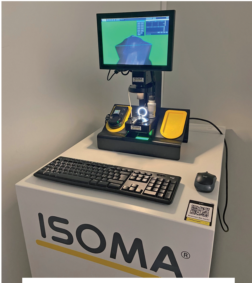
Die MINIScope™ Station double ermöglicht die Werkzeugmessung mit zwei Kameras, für eine Sicht von vorne und oben. (Bild: ISOMA GmbH)
