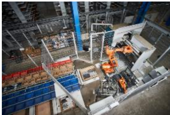
Bild 7: Der KASTOsort-Roboter entnimmt die gesägten Abschnitte aus der Säge und sortiert sie in die Paletten.
