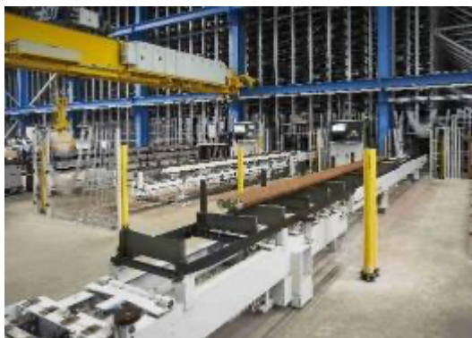
Bild 2: Eine Besonderheit des UNICOMPACT-Lagers ist, dass dieses ebenfalls das angrenzende Sägezentrum über spezielle Sägekassetten und automatisch verfahrbare Längswagen mit Material versorgt.
